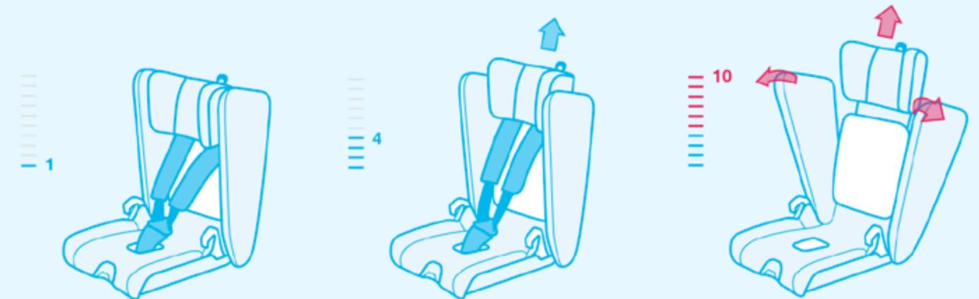
Patentiertes Sicherheitslocksystem (SLS) verriegelt im aufgeklapptem Zustand und zusammengeklappt während des Transports.
